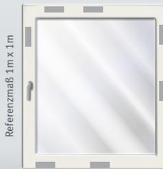
mit Sicherheitsschließstücken an allen Verriegelungspunkten\*
